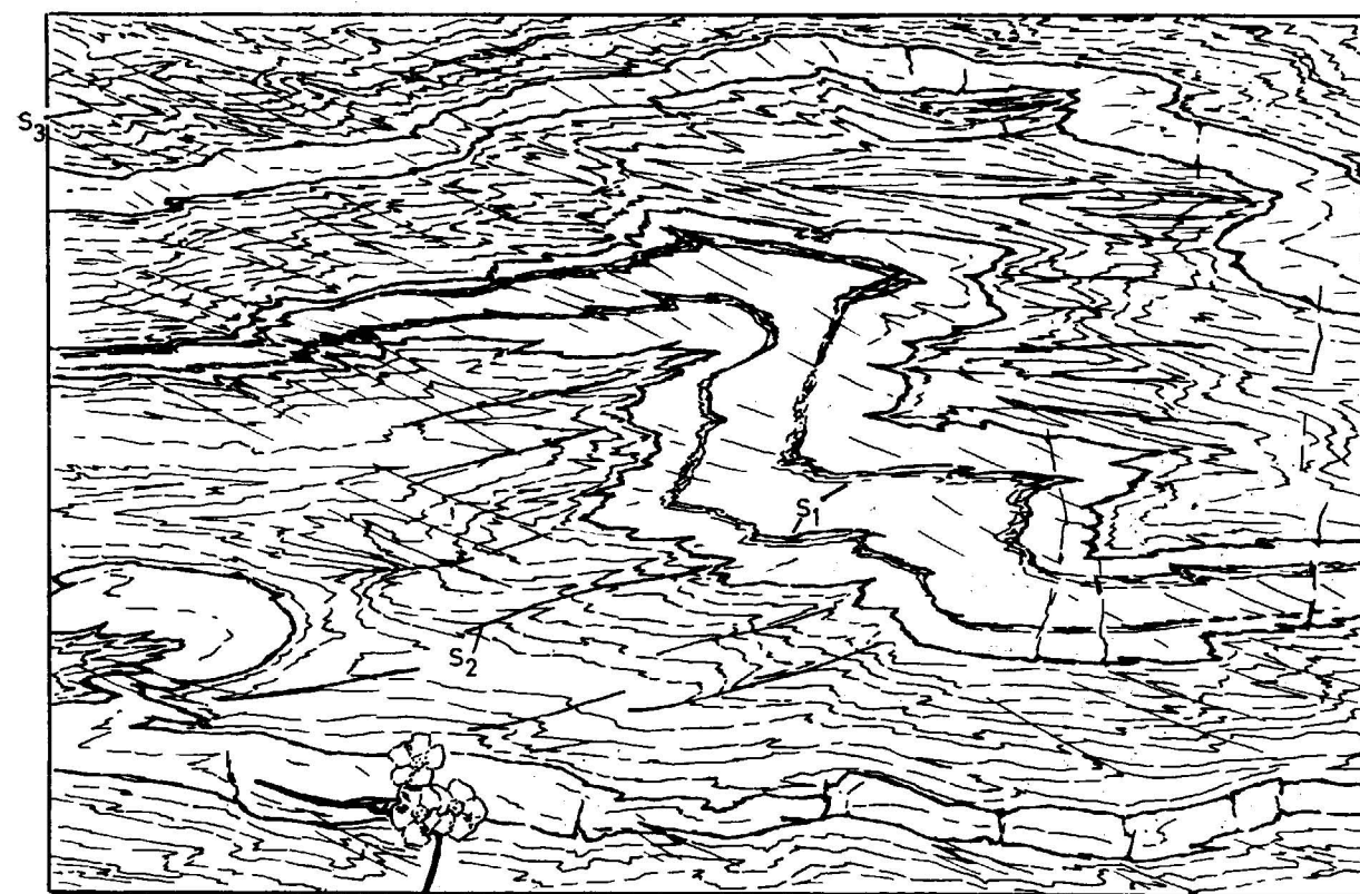
Figura 14.—Croquis ilustrativo, tomado de una fotografía, de las relaciones entre sucesivas fases del plegamiento en el Paleozoico de la unidad de Torrox (parada 5.5).
