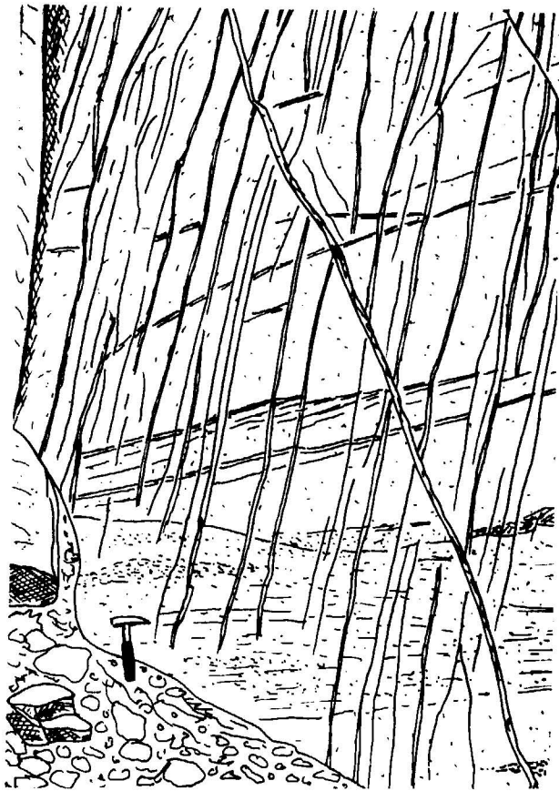
Figura 11.—Aspecto del sistema de diaclasas del granito de Barruecopardo en la pared norte de la corta del Coto Minero Merladet. El haz filoniano, que ocupa las diaclasas Q —subverticales, muy apretadas e inclinadas hacia el Oeste—, contiene la mayor parte de la mineralización. Estas diaclasas aparecen atravesadas sucesivamente por las fracturas L —subhorizontales, discontinuas y más o menos paralelas a las bandas pegmoaplíticas— y las S. Estas son también subverticales, pero más espaciadas que las Q y con buzamiento al Este.
